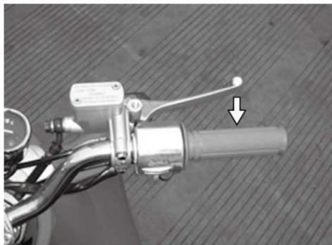
Bremshebel Vorderradbremse, gleichmäßig ziehen
