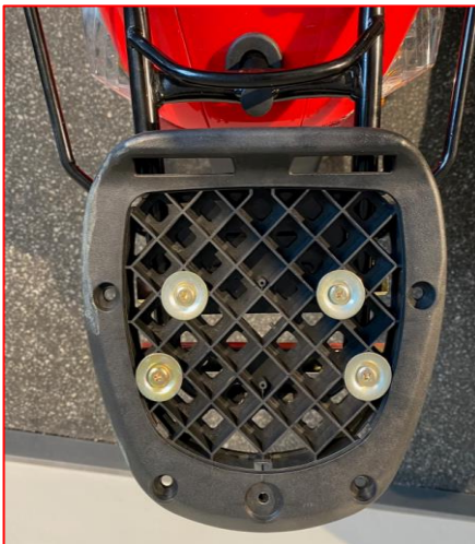
Bild 2 – fixierte Bodenplatte (Ansicht von oben)
